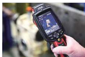
减速箱运行时的热图像检测
