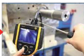
不用拆卸减速箱诊断过程中
